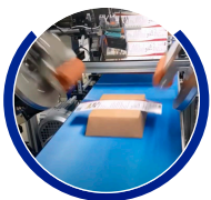
Rodillos laterales para pegado lateral y "cierre" de producto
